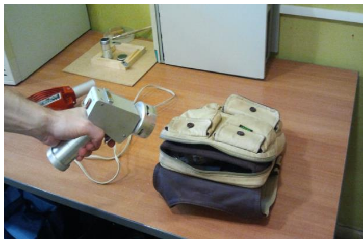
Рисунок 3.2 – Процесс отбора пробы воздуха пробоотборным устройством
