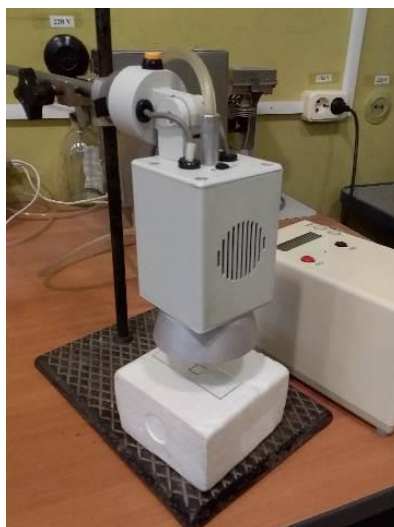
Рисунок 4.3 – Процедура отбора пробы воздуха с поверхности исследуемого объекта
