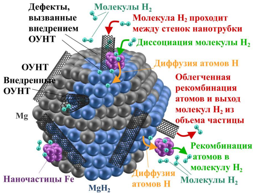
Рисунок 41 – Схема сорбции (верхняя часть) и термостимулированной десорбции (нижняя часть) водорода из гидрида магния и композита MgH_2 -5 масс.% ОУНТ
