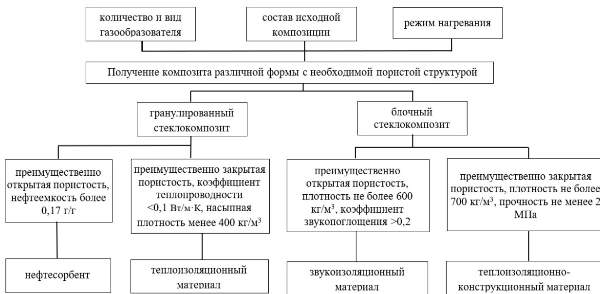
Рисунок 14 - Области применения пористого стеклокомпозита в зависимости от характеристик
