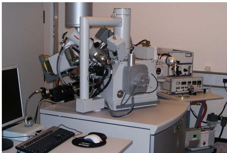
Рисунок 2.6 – Изображение сканирующего электронного микроскопа Quanta 200 3D
