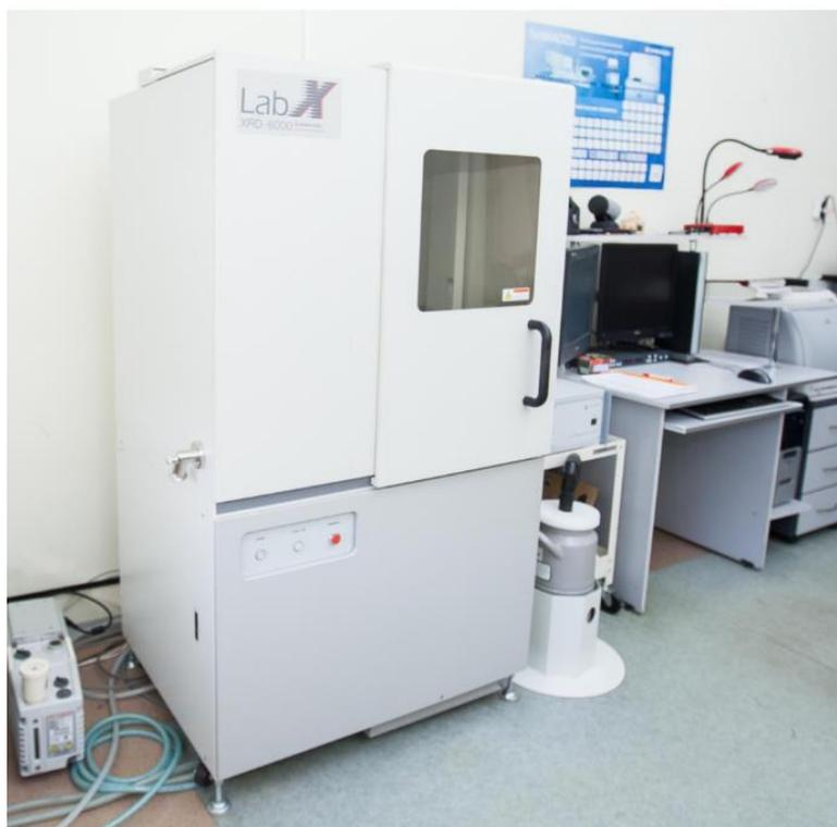
Рисунок 2.11 – Внешний вид рентгеновского дифрактометра XRD 6000
