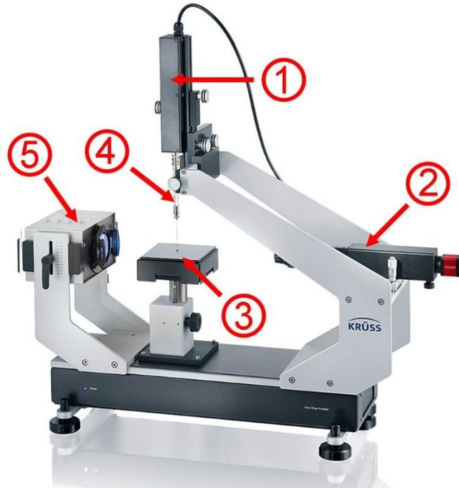
Рисунок 2.14 – Изображение системы анализа формы капли DSA 25: система дозированной подачи жидкости из шприца (1), видеокамера, фиксирующая профиль капли (2), регулируемый держатель для исследуемых образцов (3), шприц (4), регулируемое освещение, направленное в сторону камеры (5)
