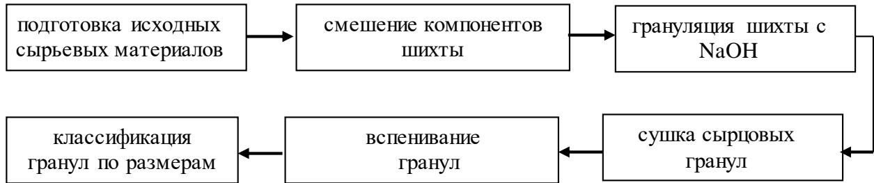
Рисунок 1.2 – Схема одностадийной технологии гранулированного пористого материала
