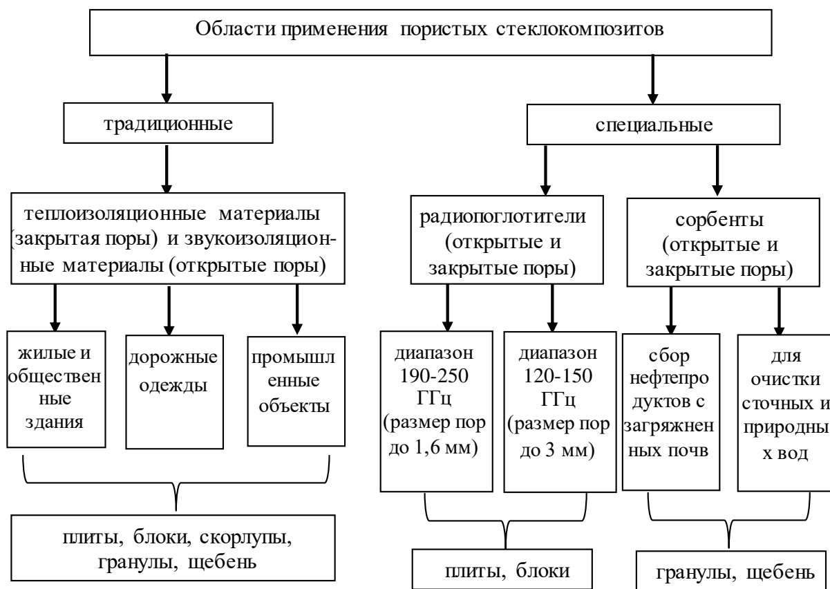
Рисунок 1.13 – Области применения пористого стеклокомпозиата в зависимости от формы и пористой структуры
