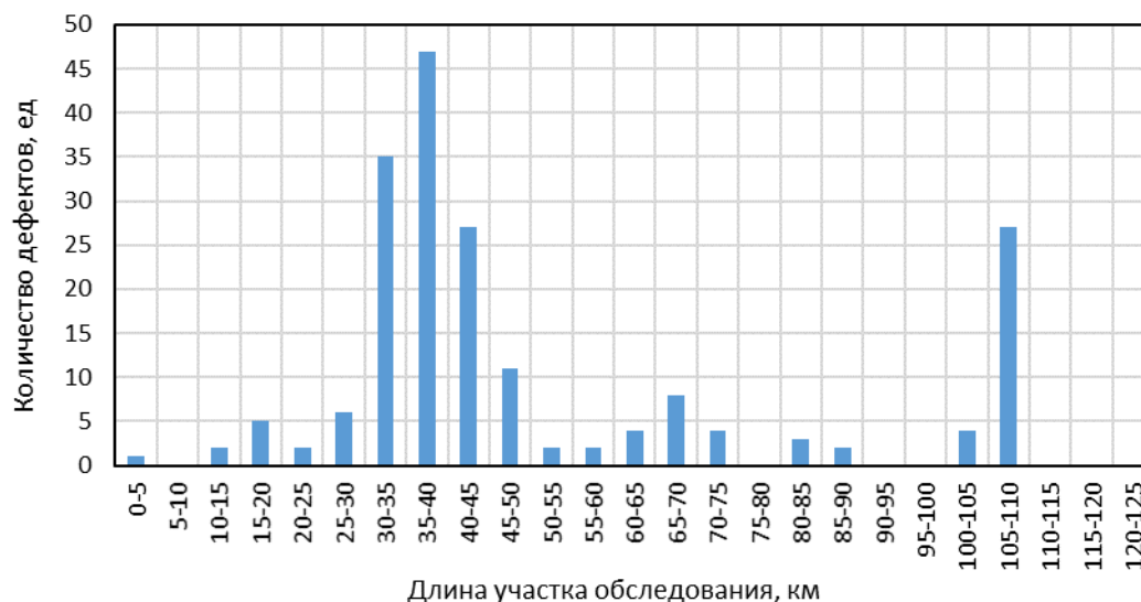
Рисунок 4.1 – Количество коррозионных дефектов по длине участка обследования газопровода Ямбург – Елец 1
