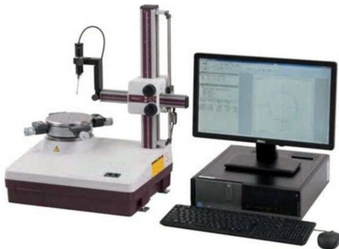
Рис. 1. Стандартный щуп кругломера (справа) и кругломер Roundtest (слева)
