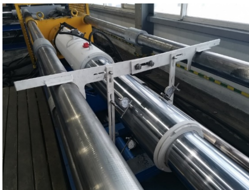
Рис. 4. Установка устройства для измерения радиальных деформаций цилиндра на стенде
