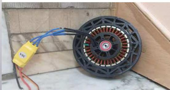
Рис. 3. Бесколлекторный мотор, изготовленный из пластика PetG
