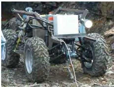
Рис. 5. Спасательный робот Gemini-Scout Mine Rescue Robot
