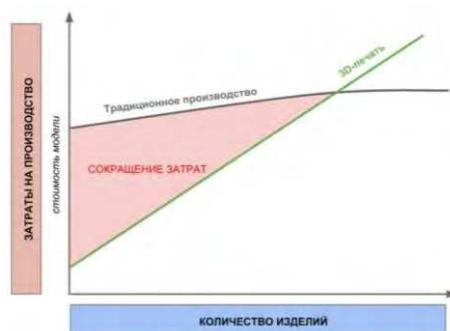
Рис. 1. График зависимости стоимости модели от кол. произведенных экземпляров показывает эффективность применения аддитивных технологий [2]
