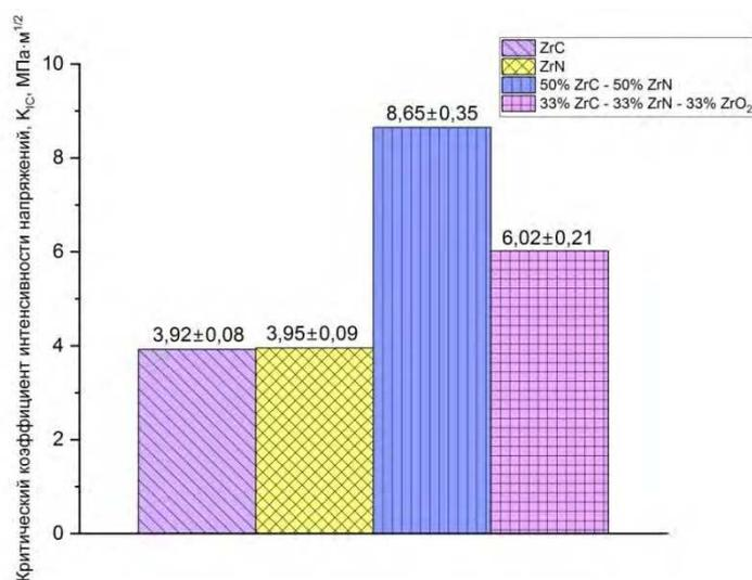
Рис. 1. Критические коэффициенты интенсивности напряжений исследуемых образцов
