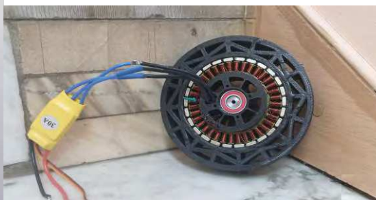
Рис. 3. Бесколлекторный мотор, изготовленный из пластика PetG
