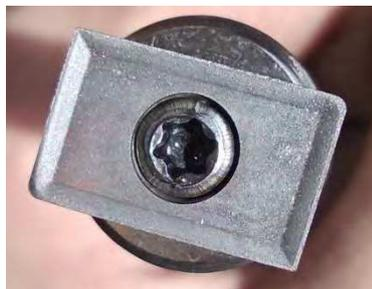
*Рис. 2. Сменная многогранная пластина ZDCT 150308 до полировки*
