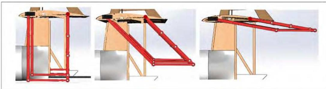
*Рис. 2. Выдвижная система электродов в разных фазах*
