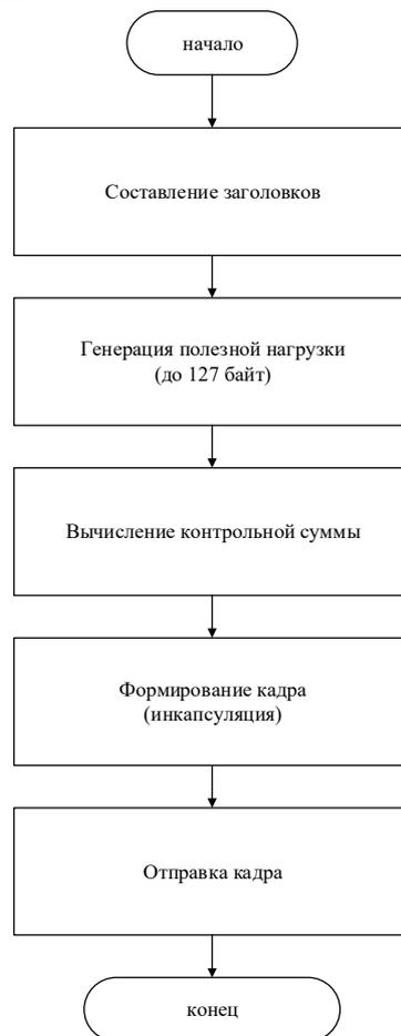
Рис. 1. Алгоритм работы программы узлов ZigBee и WirelessHART
