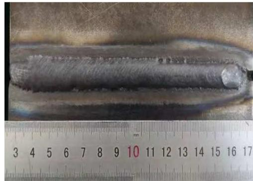
Рис. 3. Морфология формирования второго сварного шва
