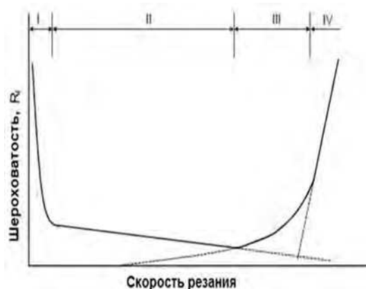
Рис. 4. Зависимость шероховатости обработанной поверхности Ra [мкм] от скорости резания v [м/мин] [1]
