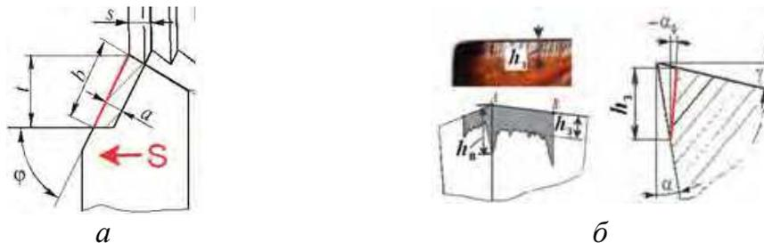
Рис. 1. Контакт главной режущей кромки с заготовкой по всей её длине в начале резания (а) и фаска износа по задней поверхности длиной  $h_3$  и с задним углом на ней  $\alpha_\phi = 0 \dots -3^\circ$  (б)
