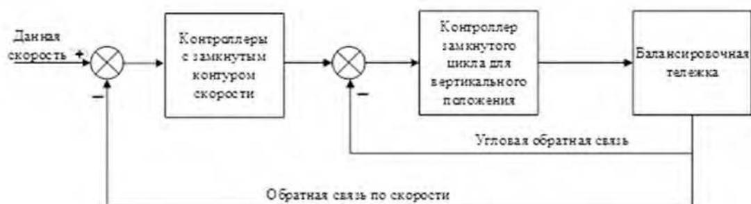
Рис. 1. Система PID с каскадным регулированием
