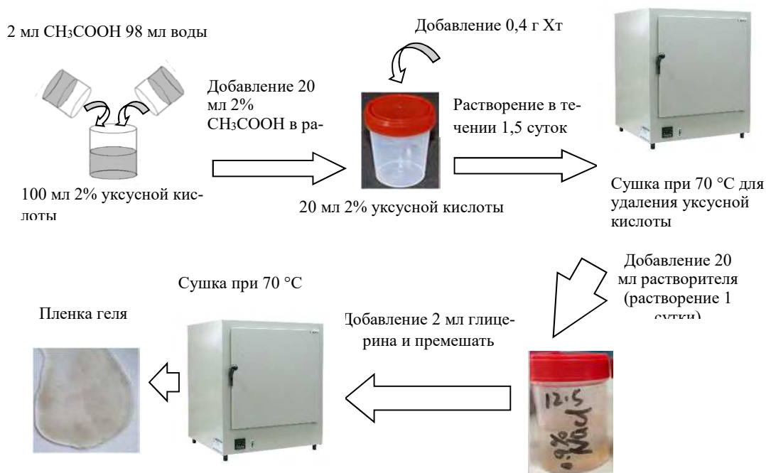
Рис. 1. Приготовление пленок гелей на основе хитозан
