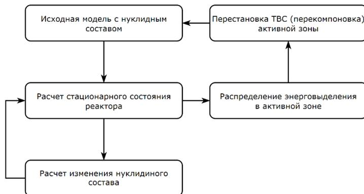
Рис. 2. Упрощенная блок-схема работы ПС MCU-PTR
