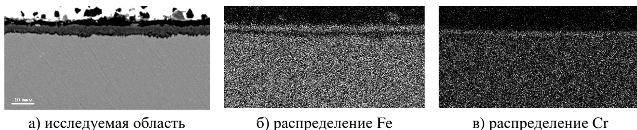
Рисунок 14 – Структура окалины, образовавшейся после испытаний при температуре 600 °С
