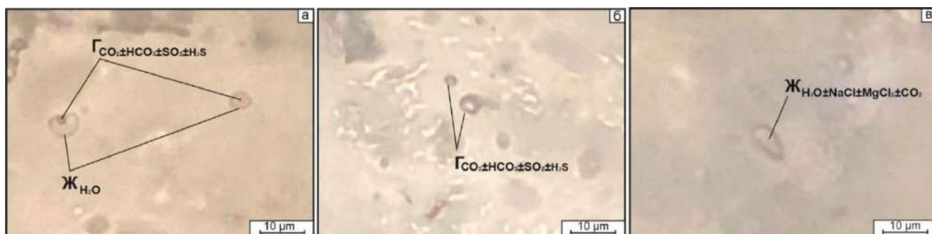
Рисунок 6.6 – Типы включений по фазовым соотношениям: двухфазные (а) Ж \text{MgHl}_2 \pm \text{NaCl} \pm \text{H}_2\text{O} + \Gamma \text{CO}_2 \pm \text{HCO}_3 \pm \text{SO}_2 \pm \text{H}_2\text{S} ; однофазное газовое (б) \Gamma \text{CO}_2 \pm \text{HCO}_3 \pm \text{SO}_2 \pm \text{H}_2\text{S} , однофазное жидкое (в) Ж \text{MgHl}_2 \pm \text{NaCl} \pm \text{H}_2\text{O}
