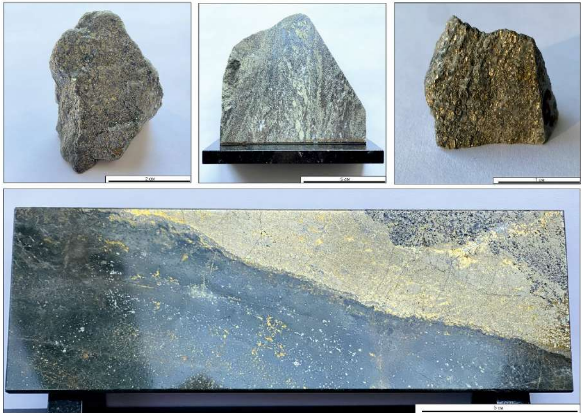
Рисунок 4.24 – Снимки руд месторождения Малеевское. а, б, в – вкрапленный тип, г – сплошной (сливной) тип
