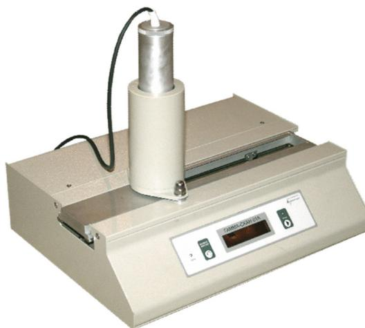
Рисунок 2.8 – Гамма-детектирующая установка «ГАММАСКАН-01А» для тонкослойной хроматографии
