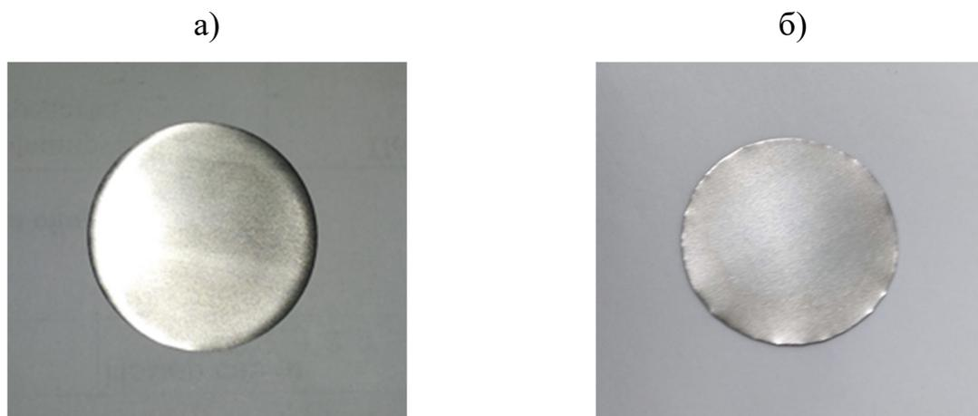
Рисунок 2.4 – Мишени из природного циркония. а) Диск диаметром 33 мм и толщиной 1,5 мм, б) Диск диаметром 33 мм и толщиной 125 мкм.
