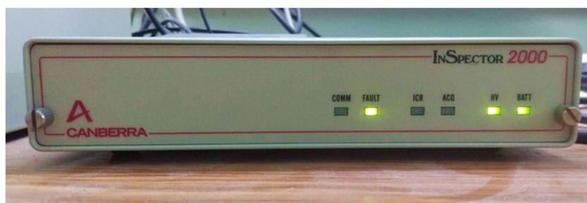
Рисунок 2.7 – Многоканальный анализатор Canberra InSpector 2000.
