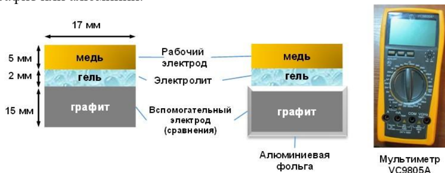
Рис. 1 Схема ячеек для измерения электродного потенциала
