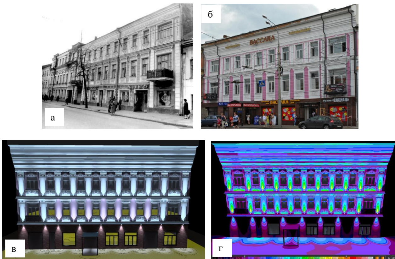
Рис. 1. «Дом Белоусова», конец XIX в., г. Ярославль, ул. Комсомольская, д. 8: внешний вид здания в 1990 г. (а) и в 2016 г. (б), визуализация освещения (в) и расчёт в фиктивных цветах (г) фасада здания в программе DIALux evo
