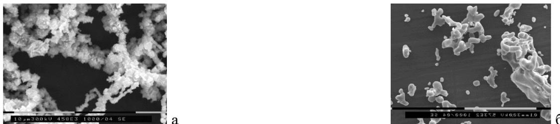
Рис. 1. Внешний вид исходных порошков никеля (а) и титана (б)
