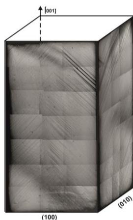
Рис. 1. Деформационный рельеф в монокристалле 1
