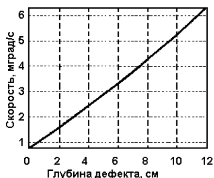
Рис. 10. Зависимость скорости убывания температурного контраста от глубины дефекта при импульсном воздействии воздушным потоком
