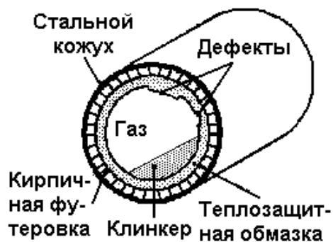
Рис. 1. Цементная печь в разрезе
