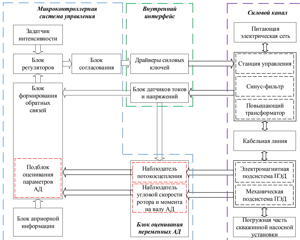
Рис. 5. Электромеханическая система с регулируемым асинхронным двигателем и косвенным методом измерения переменных состояния
