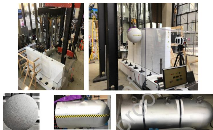
Рис. 7. Маятниковый копер и варианты ударяющего груза
