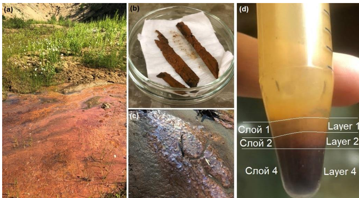
Рис. 2. Фото корок вторичных минералов в долине источника Суллар (а–с) и гидрогенных минералов, высадившихся из отобранной пробы воды источника Суллар в лабораторных условиях (d) с разделением по визуально выделенным слоям: Слой 1 – верхний, светло-желтый (осаждался последним); Слой 2 – средний, красновато-бурый; Слой 3 – ядро, светло-бурый (не показан на рисунке); Слой 4 – нижний, темно-бордовый (осаждался первым)
