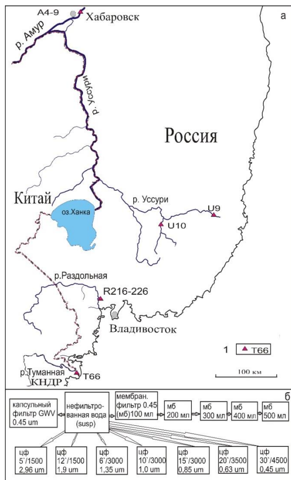
Рис. 1. Схема района работ (а) с расположением точек отбора речных вод (1) и схема обработки нефильтрованных проб речной воды (б) с использованием различных способов фильтрации и режимов центрифугирования: мб – фильтрация через мембрану 0,45 мкм, цф – центрифугирование с расчетным минимальным диаметром осаждаемых частиц, μm (мкм)
