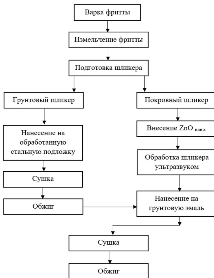
Рисунок 10 – Технологическая схема получения антибактериальной эмали
