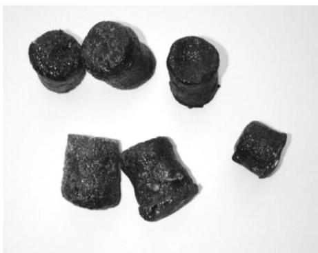
Рисунок 4.8 – Прессовки шихты после термообработки
