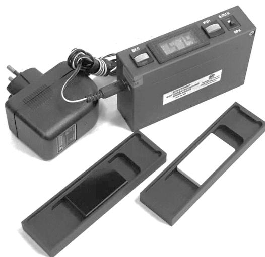
Рисунок 2.14 – фотоэлектрический блескомер ФБ-2
