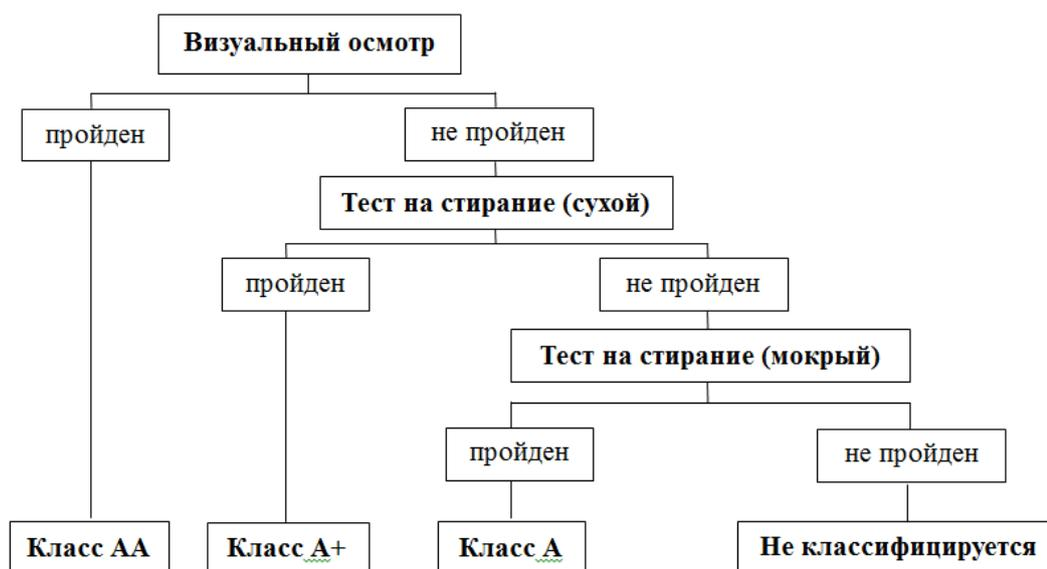
Рисунок 2.9 – Схема тестирования химической стойкости эмали
