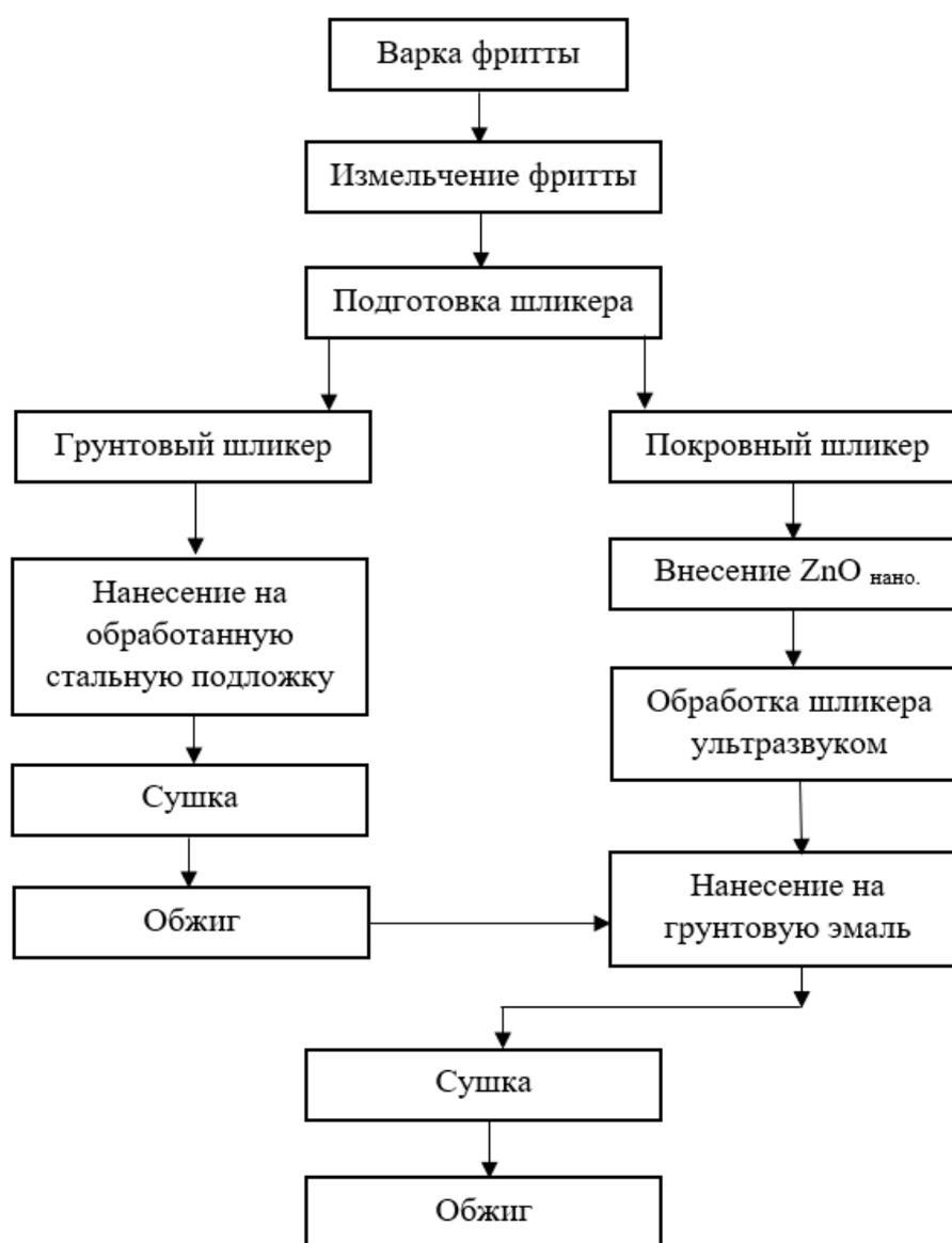
Рисунок 5.2 – Технологическая схема получения антибактериальной эмали
