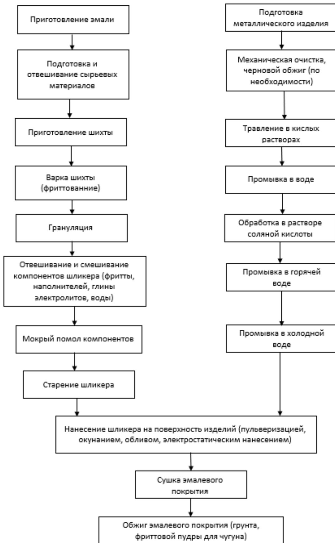
Рисунке 1.7 – Технологическая схема эмалирования чугуна и сталей
