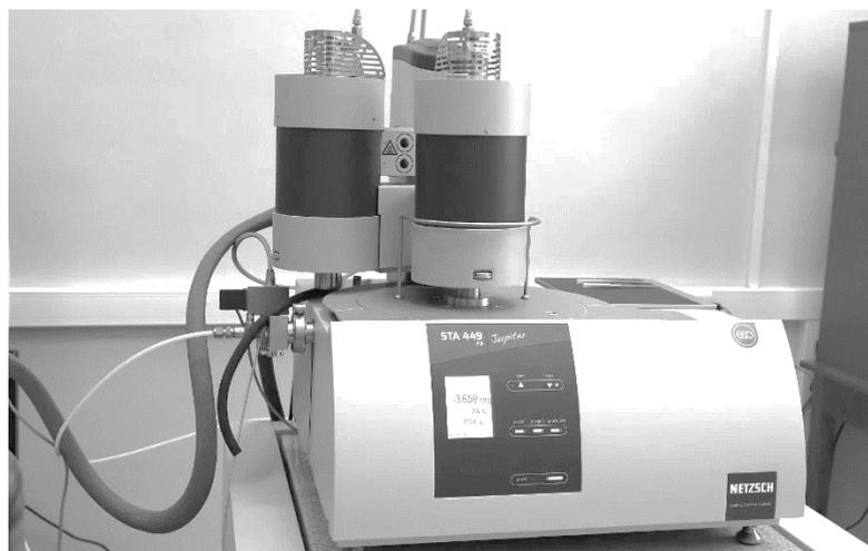
Рисунок 2.11 – Прибор синхронного термического анализа ТГ-ДТА/ДСК STA 449 Jupiter
