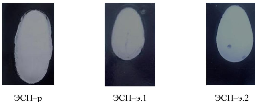
Рисунок 3.1 – Фотографии образцов эмали после определения растекаемости
