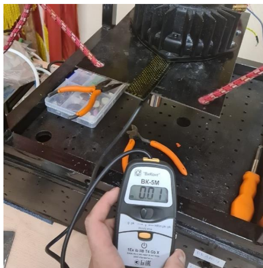
Рис. 1. Стенд для виброиспытаний с виброметром
