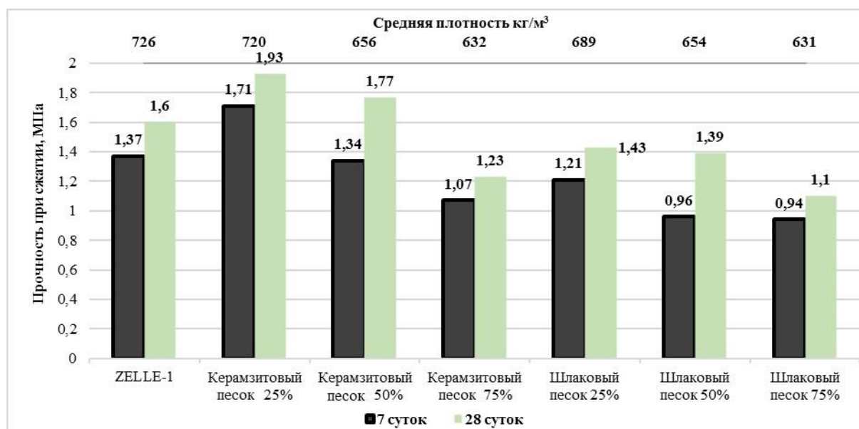
Рис. 1. Результаты влияния пористых заполнителей на прочностные свойства пенобетона
