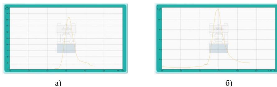
Рис. 2. Результаты испытания бетонных образцов-кубиков на сжатие после 14 суток выдерживания:
