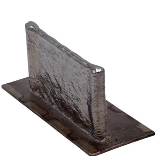
Рис. 1. Внешний вид образцов после печати
