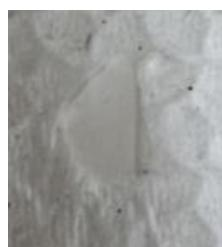
Рис. 4. Пленка АОА, полученная после погружения в 5 % раствор  $\text{H}_3\text{PO}_4$  на 1 ч, (оптический микроскоп, увеличение х20)
