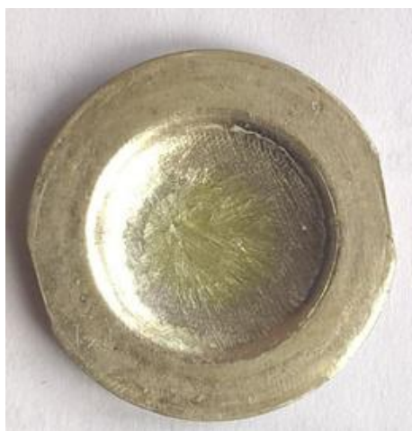
Рисунок 2 — Мишень из \text{TeO}_2 , наплавленного на Pt подложку
