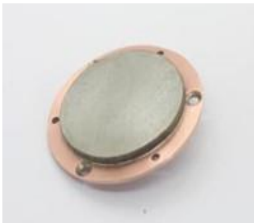
Рисунок 1 — Мишень из металлического Те, созданная с помощью электроосаждения
