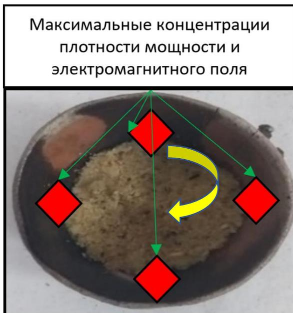
Рисунок 2.5.3.1 - распределение точек концентраций электромагнитного поля и мощности на нагреваемом сырье в реакторах с одним магнетроном.
