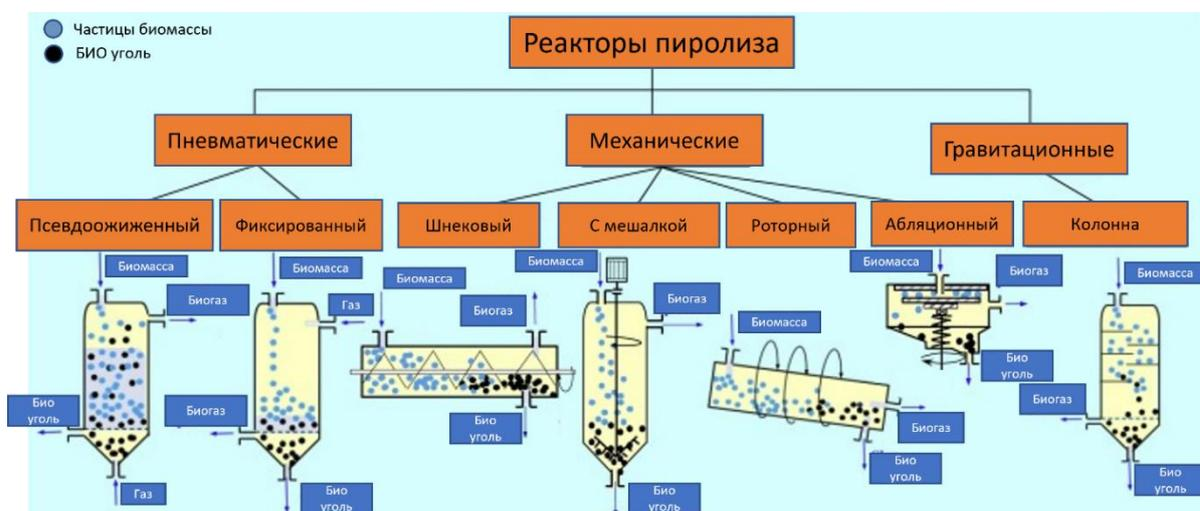
Рисунок 1.3.1 - виды реакторов-пиролизеров [80].
