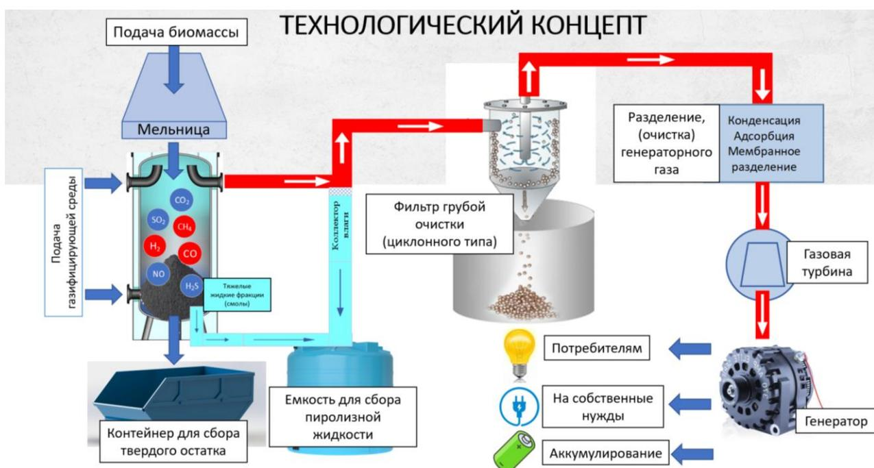
Рисунок 4.1.2 - технологическая схема микроволнового пиролиза.
