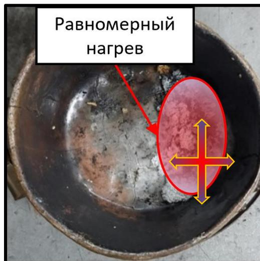
Рисунок 2.5.3.6 - нагрев при плотной структуре поверхности навески.
