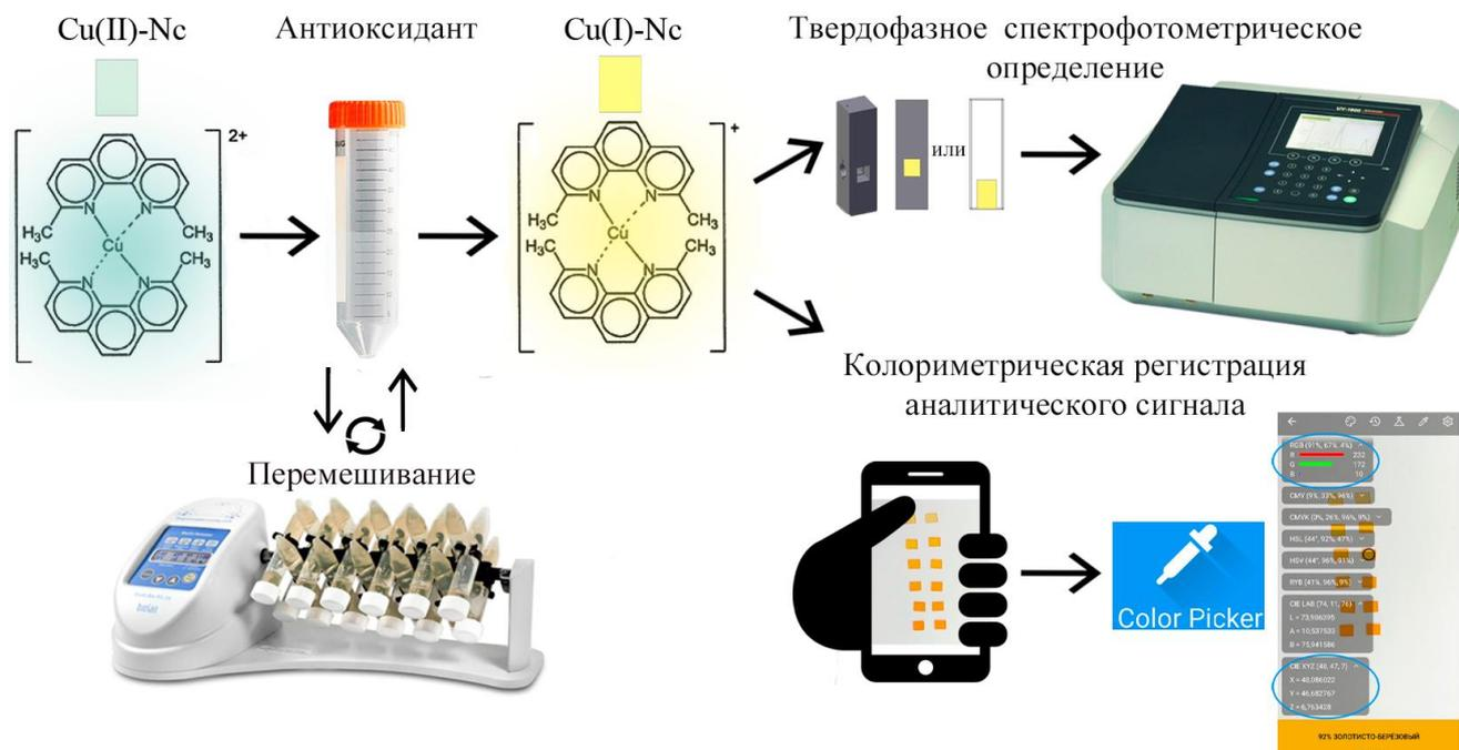
Рисунок 14 – Схема определения  $\Sigma$ АО методом CUPRAC
