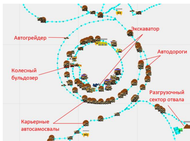
Рис. 1. Визуализация модели транспортной системы карьера в окне программы «ТСК»
