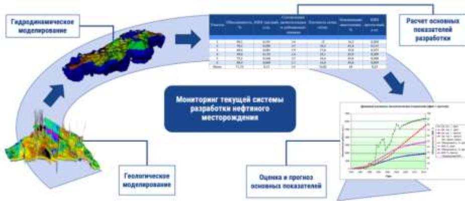
Рис. 1. Краткая последовательная схемы мониторинга текущей системы разработки нефтяного месторождения
