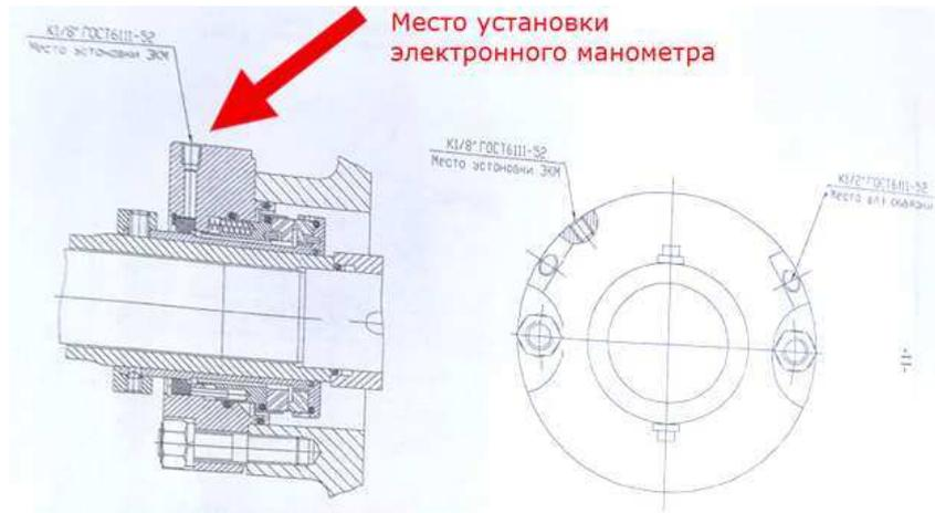
Рис. 4. Место установки электронно-контактного манометра
