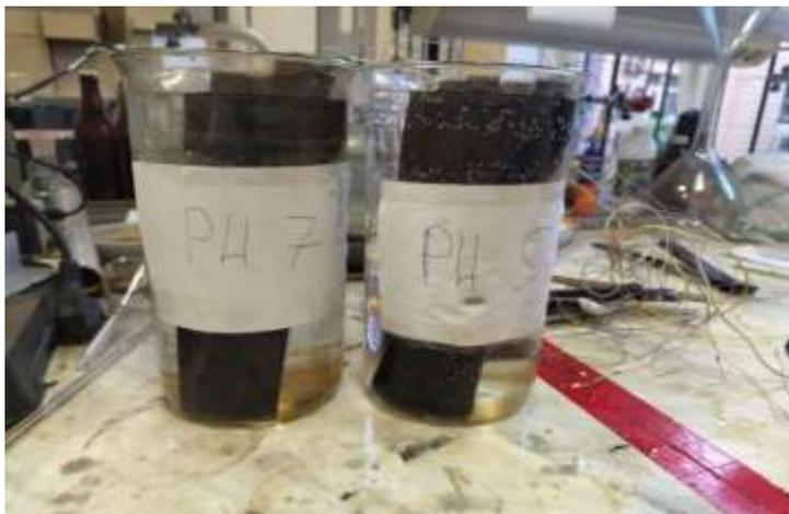
*Рис. Процесс выдержки образцов в различных средах*
