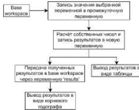
Рис. 1. Структурная схема актуальной версии программного обеспечения
