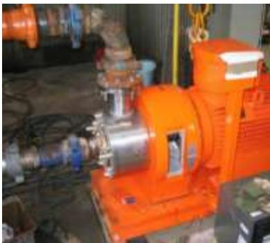
*Рис. 1. Общий вид диспергатора Silverson*
