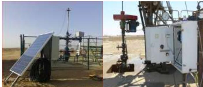
*Рис. 1. Состав оборудования системы дистанционного контроля*
