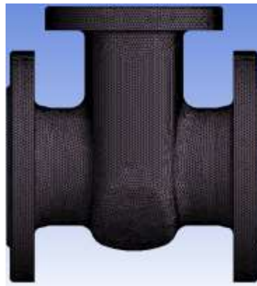
Рис. 2. Модель, разбитая на конечные элементы
