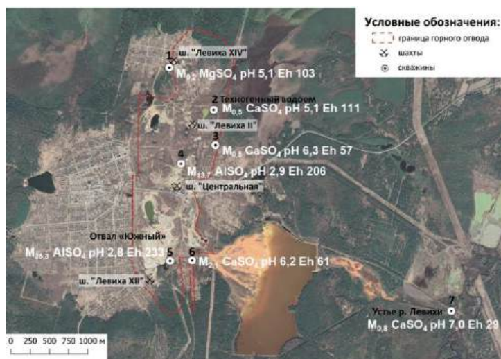
Рис. 1. Схема размещения пунктов гидрохимического опробования скважин и химический состав воды в них: 1 – возле ш. «Левиха XIV»; 2 – возле техногенного водоема; 3 – возле ш. «Левиха II»; 4 – возле ствола ш. «Центральная»; 5 – возле отвала «Южный»; 6 – возле станции нейтрализации; 7 – ниже сброса с пруда-осветлителя, в устье р. Левихи
