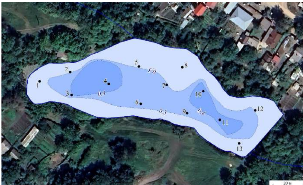
Рис. Схема отбора проб донных осадков и результаты батиметрической съемки пруда
