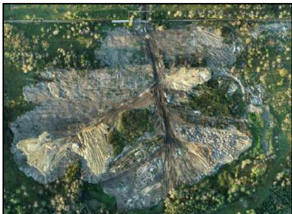
Рис. 2. Ортофотоплан полигона ТКО, подготовленный в результате обработки съемки с БПЛА (по результатам аэрофотосъемки)
