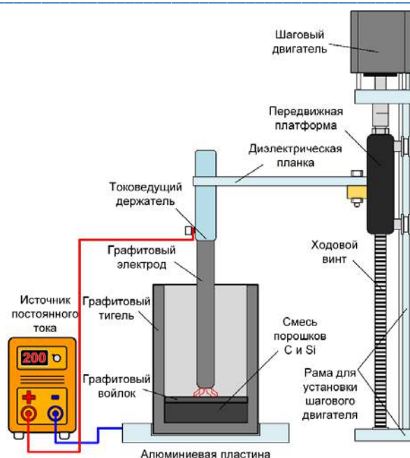
Рисунок 1. Схема устройства реакционной зоны безвакуумного электродугового реактора
