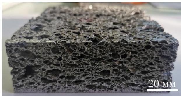
**Рис. 1.** Фрагмент твердотельного демпфера на основе пеноалюминия
