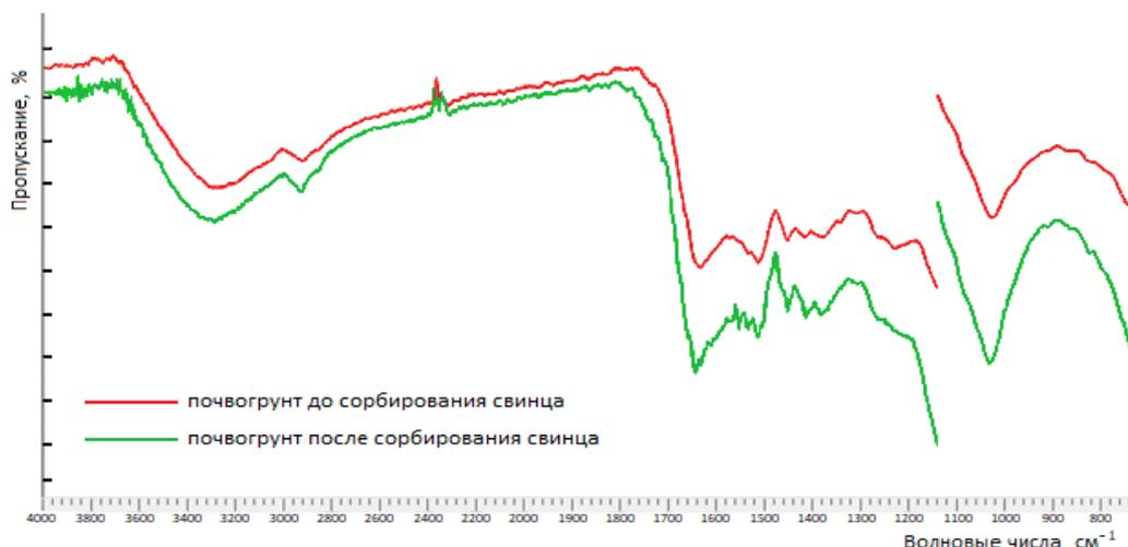
**Рис. 4.** ИК-спектры поверхности полученного сорбента до (1) и после (2) сорбирования ионов свинца
