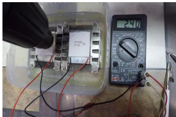
Рис. 7. Генерация энергии с помощью модулей Пельтье (два модуля) Fig. 7. Energy generation using Peltier modules (two modules)
