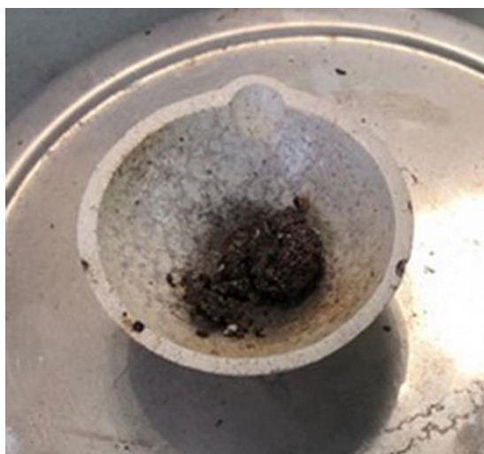
Рис. 1. Биоуголь, полученный при обработке куриного помета СВЧ-плазмой в течение 4 минут
