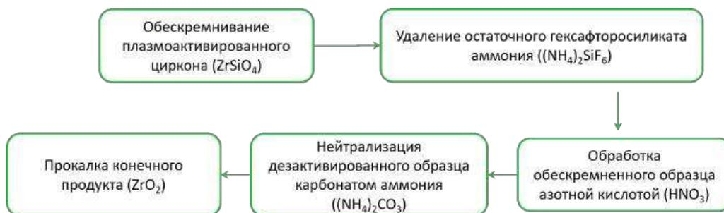
Рис. 1. Схема переработки цирконового концентрата
