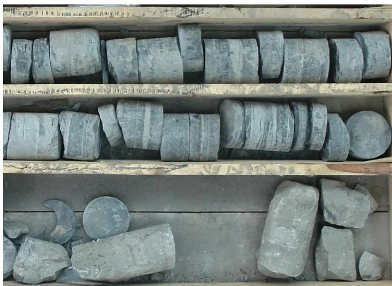
Рис. 6. Пример раздробленных образцов керна для анализа
