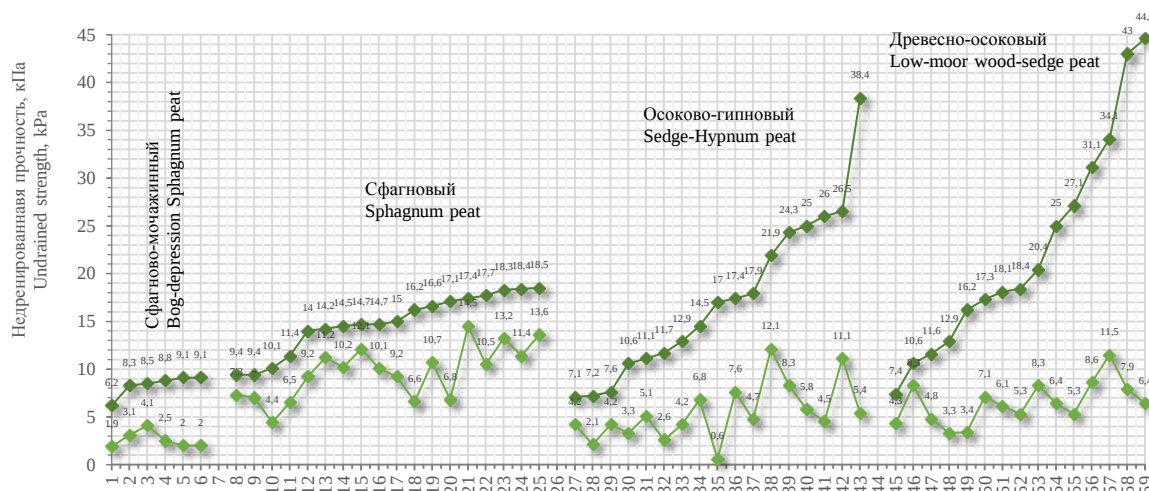
Рис. 2. Недренированная прочность торфов (пиковые значения прочности – верхняя кривая, в нарушенном состоянии – нижняя)
