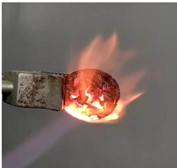
Рис. 1. Испытание полученного состава на огнеупорность
