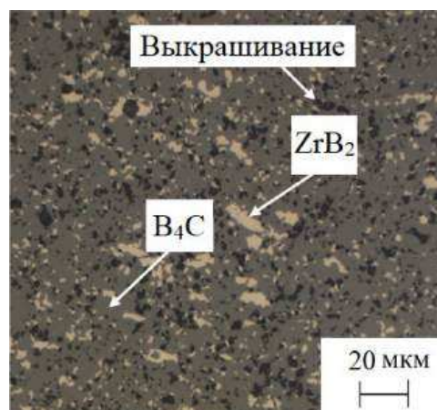
Рис. 1. Микроструктура композиционной керамики B_4C - 10 \text{ мол. \% } ZrB_2
