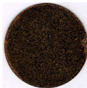
Рис. 2. Фото пластика после прессования в закрытой пресс-форме: — граница краевой зоны и зоны истинного пластика
