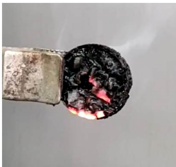
Рис. 1. Испытание полученного состава на огнеупорность
