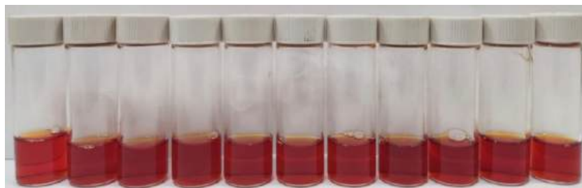
Рис. 1. Образцы наночастиц селена, стабилизированных бычьим сывороточным альбумином, с добавлением буферных растворов
