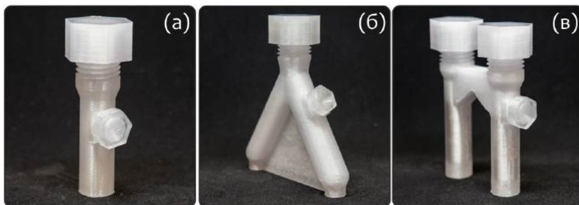
Рис. 1. Реакторы для проведения реакций под давлением с резьбовой крышкой и боковым элементом безопасности для сброса давления: (а) однокамерный реактор I-tube; (б) двухкамерный реактор Y-tube; (в) двухкамерный реактор H-tube
