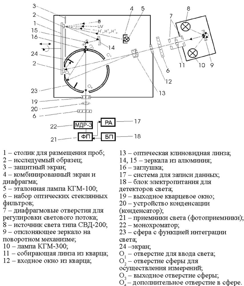
Рисунок 2.11 – Схема измерения спектров диффузного отражения в установке «Спектр-1» [273]
