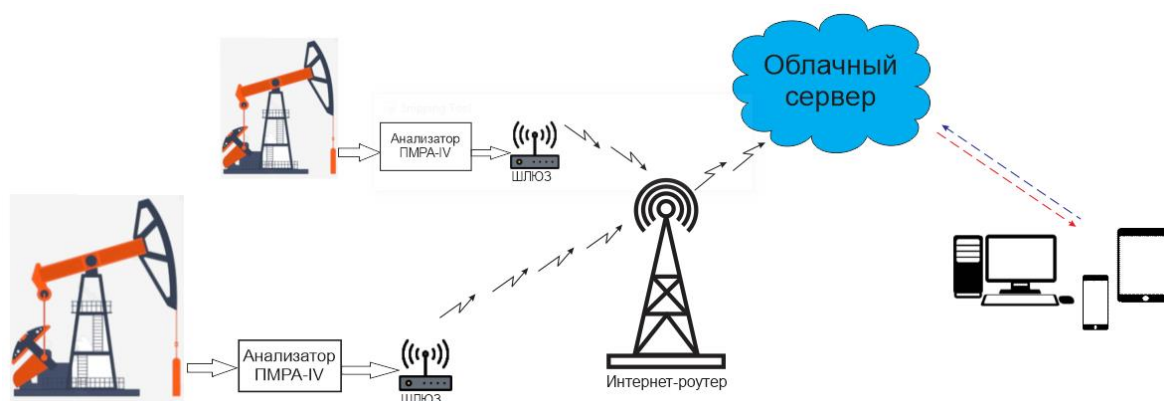
Рис. 1. Мониторинг и контроль выходных параметров анализатора ПМРА-IV на базе ИВ
