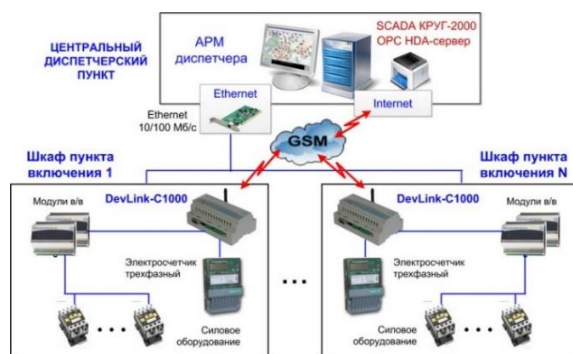
Рис. 2. Структура АСУ наружным освещением
