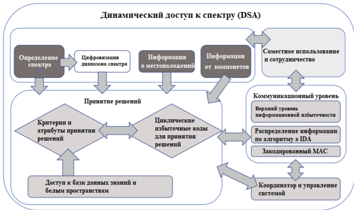
Рис. 2. Упрощенная структурная схема предполагаемого устройства CR
