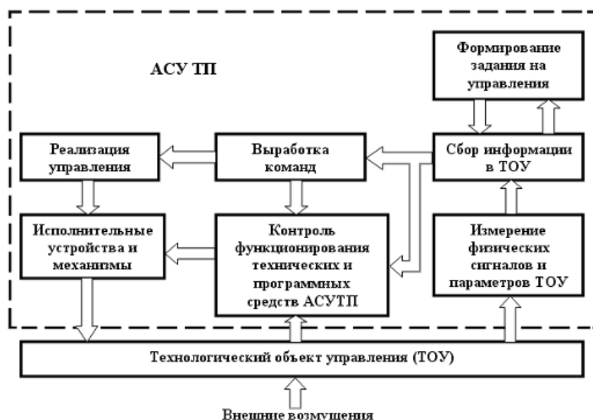
Рис. 2. Блок-схема автоматизированной системы управления технологическими процессами
