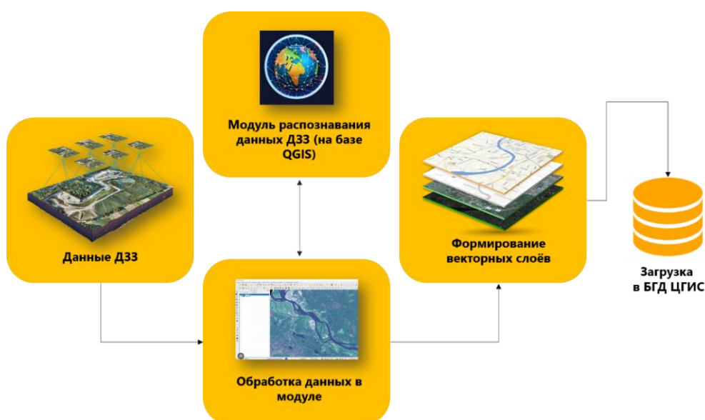
Рис. 3. Архитектура взаимодействия модуля распознавания данных ДЗЗ
