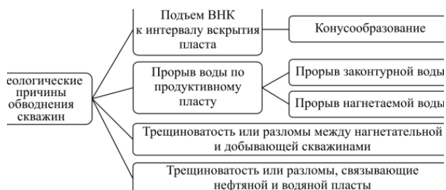
Рис. 3. Геологические причины обводнения скважин
