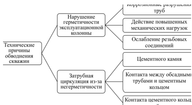
Рис. 2. Технические причины обводнения скважин
